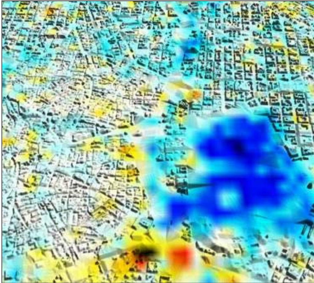
Mapa de temperatura del centro de Madrid a partir de una imagen Aster
