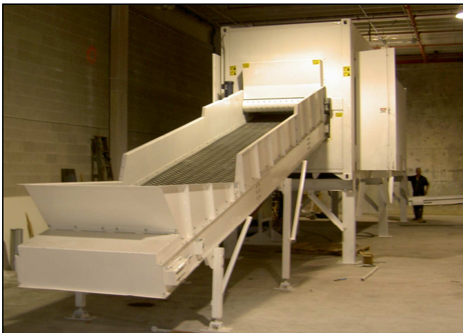
E Alimentador del sistema reciclaje para yeso de "Andela Products". Modelo AGBR-11
